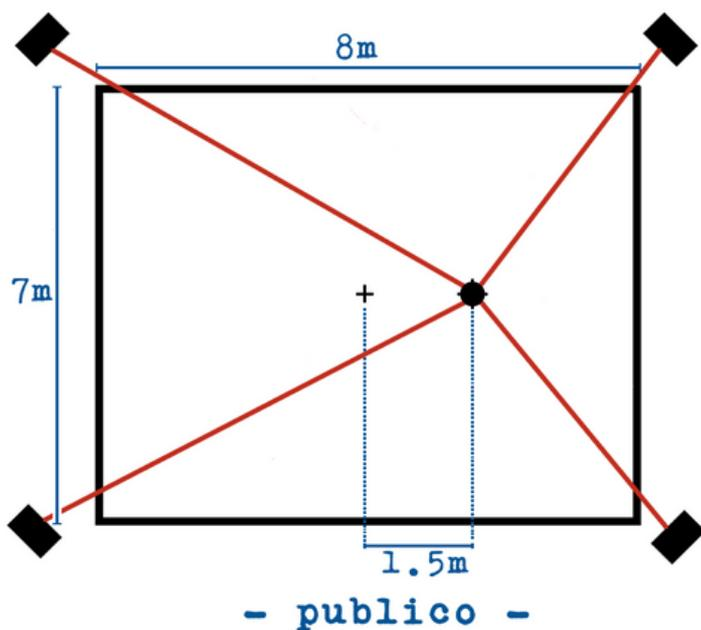
Necesidad de **4 de puntos anclaje de 500kg minimo** cada uno (sacos de arena, farolas, bancos, fuentes, furgonetas, contrapesos...) a 6m y maximo a 10m del mástil, dispuestos como en el dibujo al lado.
